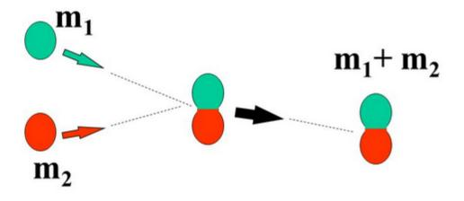
Las colisiones inelásticas la energía aparece en otras formas y la energía cinética inicial y final no son iguales en una colisión inelástica la energía mecánica U + K no se conserva pero la energía total si.
