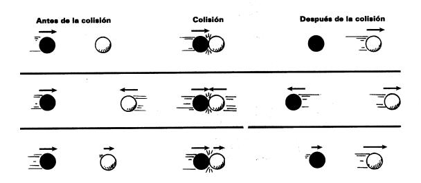
Despreciamos todas las demás formas de energía que consideramos solamente a la energía mecánica U+K, suponemos que en una colisión impulsiva las fuerzas están actuando durante un tiempo corto y por lo tanto sobre una distancia corta, además observamos a las partículas solamente con una separación relativa mucho más grande de modo que los efectos de su energía potencial internas pueden ser despreciados.
