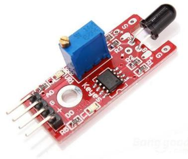
Lo que haremos será conectar el sensor a la protoboard. Luego conectarle en el VCC o corriente desde la misma protoboard y el GND, y desde la palca Arduino conectar el pin digital que deseemos a la parte que dice DO.
