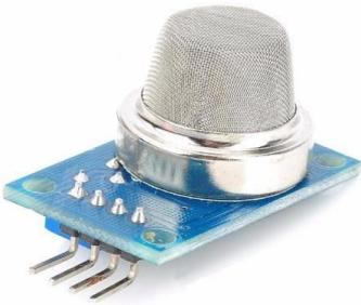
La serie MQ de sensores usan un pre-calentador en su interior y un sensor electroquímico. Son sensible a una gran cantidad de gases. El MQ2 es particularmente sensible al gas natural de hornallas lo que lo hace ideal para domótica. También detecta LPG butano, propano, metano, alcohol, hidrógeno y "humo". (GNC metano hidrogeno LPG monóxido CO propano).
