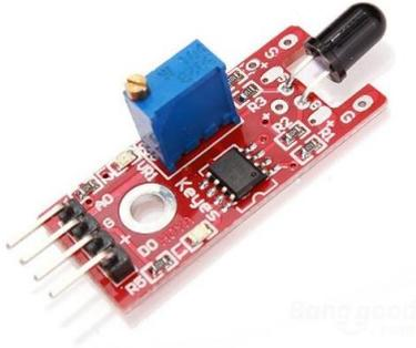
El Sensor KY 026 es capaz de detectar llamas y posee una estructura LED detectora de fuego, cuando el circuito capta las ondas emitidas por la llama este enciende una advertencia de tal modo que enciende un red. Este singular sensor está conectado a 3 interfaces digitales del LED.
