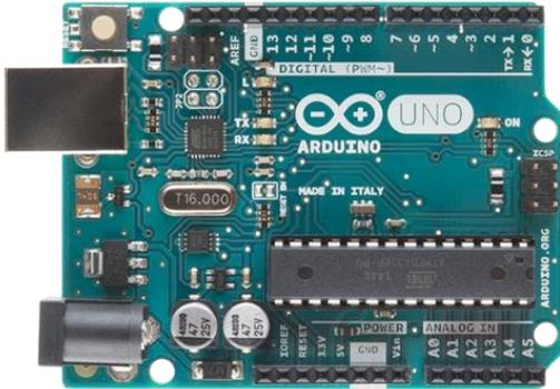
La placa **Arduino Uno**, es una de las placas más conocidas, debido a que ha sido la placa, por la cual muchos han descubierto el mundo de la electrónica y la programación. Sirve para realizar proyectos sencillos.
