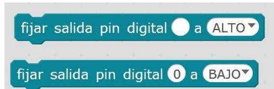
Ilustración 35: Fijar Salida Digital ALTO – BAJO
