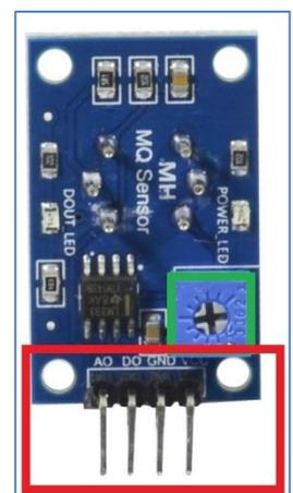
Ilustración 11: En verde: Potenciómetro | En Rojo: Pines de Conexión.
