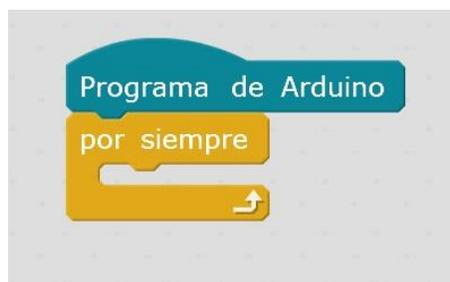
Ilustración 21: Bloques -> Programa Arduino y por siempre
