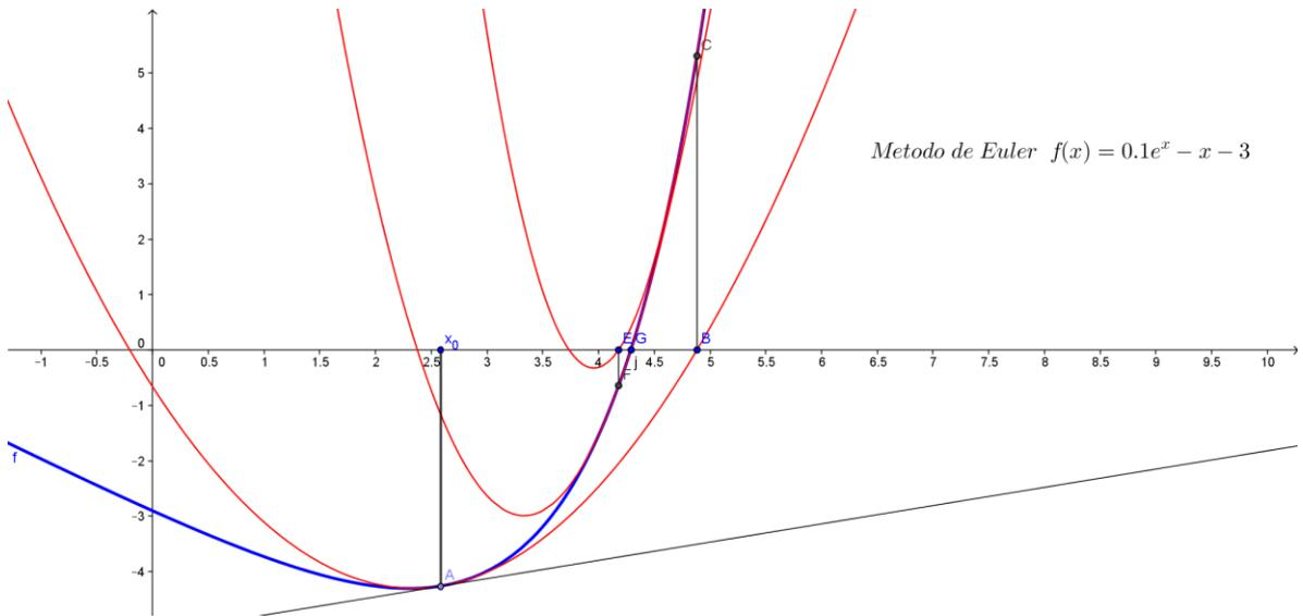
Se observa en la figura, que por el punto inicial  $A(x_0, f(x_0))$ , pasa la parábola osculadora – Euler- y la recta tangente –Newton-, siendo evidente la ventaja comparativa de Euler sobre Newton. Se destaca en la gráfica la sucesión aproximante de las parábolas osculatrizes y la formula iterativa de Euler permite calcular los puntos de la sucesión aproximante  $x_1=B$ ,  $x_2=E$ ,  $x_3= G$ , etc.
